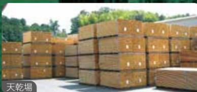
仕入れ製品(原板・グリーン・製材品)の受取・検収・棧積・天日乾燥・人工乾燥・養生
