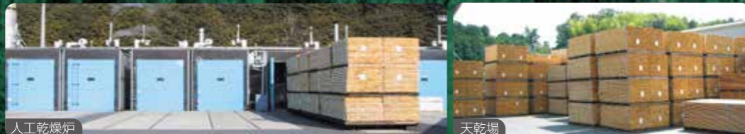
仕入れ製品(原板・グリーン・製材品)の受取・検収・棧積・天日乾燥・人工乾燥・養生
